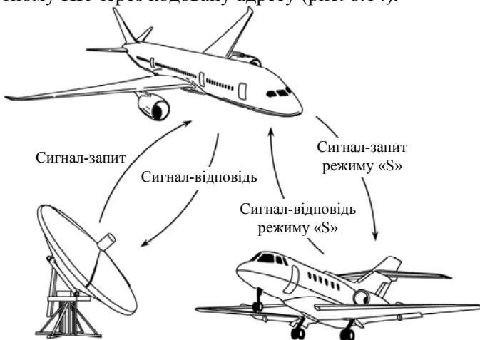
Рис. 8.14. Використання ATCRBS режиму «S»
