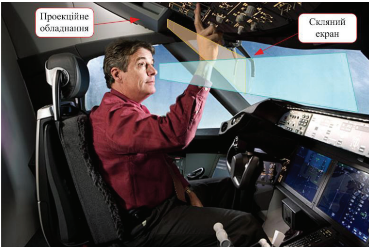
Рис. Д57. Принцип функціонування HUD В-787
