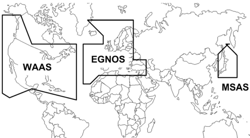
Рис. 7.25. Зони дії функціональних доповнень GNSS
