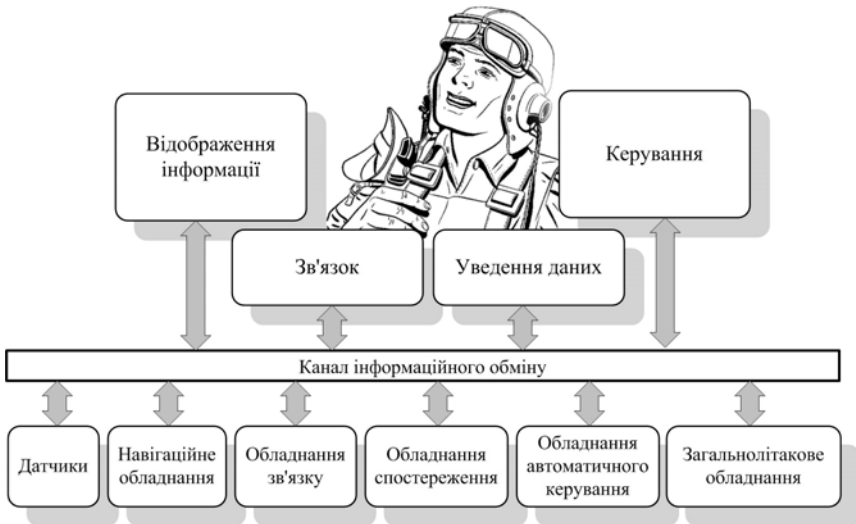
Рис. 1.4. Взаємодія систем авіоніки
