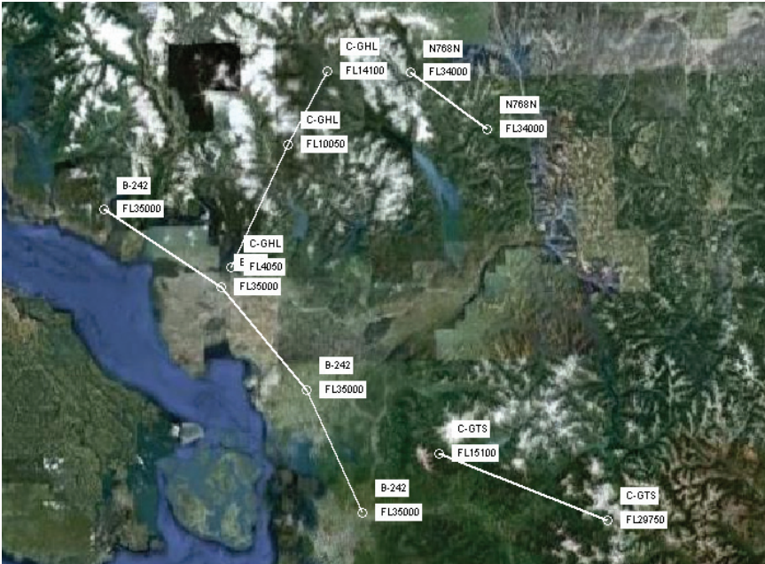
Рис. Д32. Моніторинг повітряного руху за повідомленнями ACARS [91]
