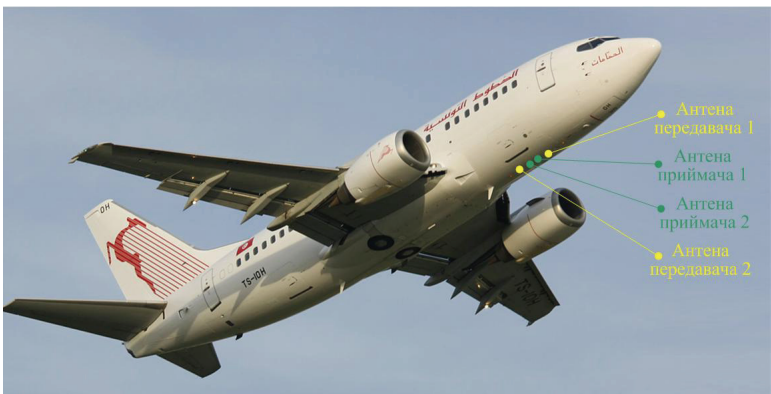
Рис. Д19. Розміщення антен RAL на B737
