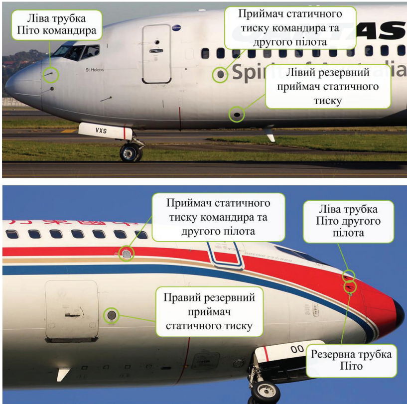
Рис. Д5. Розміщення датчиків тиску на борту літака В-737
