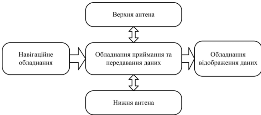
Рис. 8.10. Типова структура бортового обладнання концепції ADS-B
