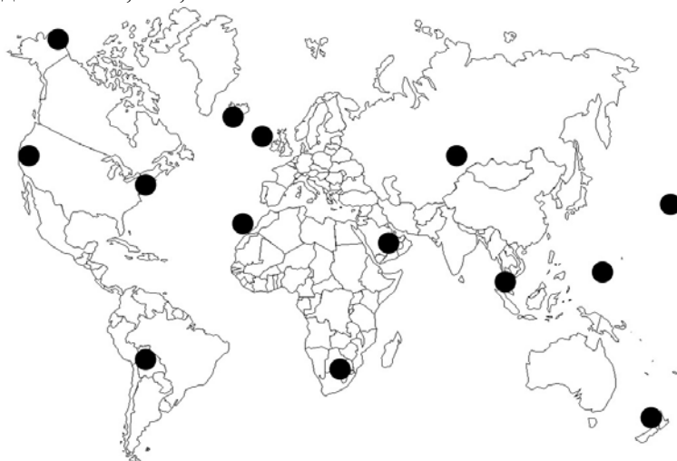
Рис. 8.2. Розміщення наземних станцій HFDL
