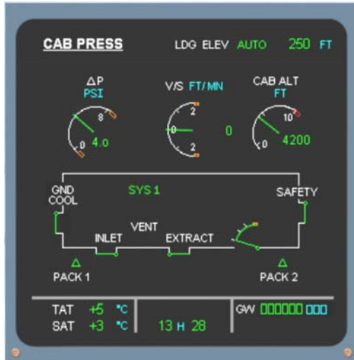
Рис. 12.17. Відображення параметрів, пов'язаних з тиском на дисплеї ECAM
