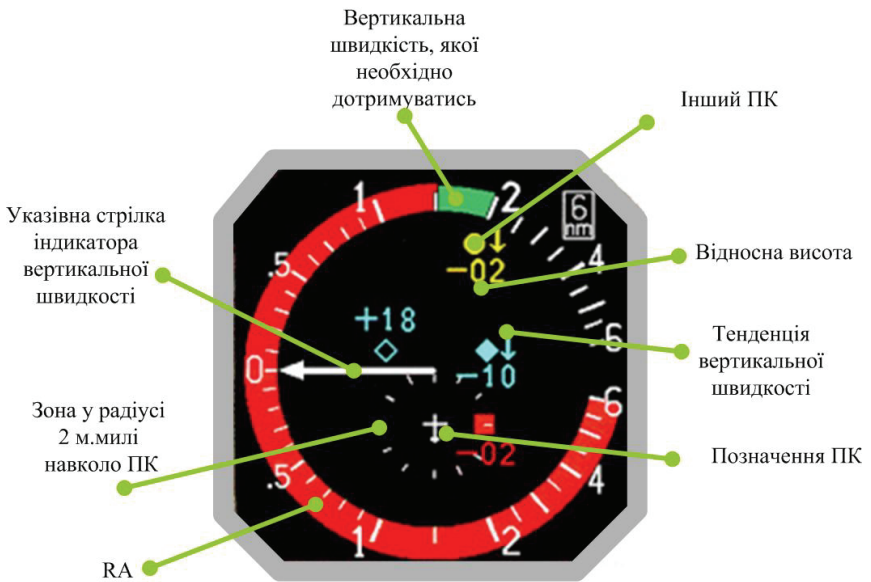
Рис. Д23. Відображення інформації на дисплеї VSI/TDI [9]
